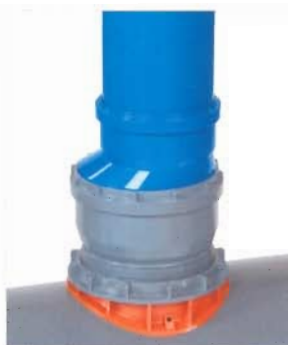
Raccordement d'un tuyau HS pour eaux de pluies DN 160 à l'aide d'une réduction (0,5 - 5,0 m SLW 60)
