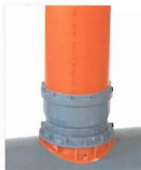
Raccordement d'un tuyau DN 200 classe de résistance SN4 (1,0 - 3,5 m SLW 30)
