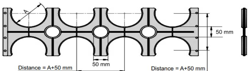
Support du tube au min. 18.5 mm
